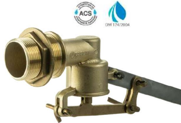
Válvula de flotador de 5 pinos apta para tanques y tanques de almacenamiento, Cuerpo en CW617N, Equipado con brazo operador en acero inoxidable AISI 430, forma redonda para bolas con conexión roscada,
